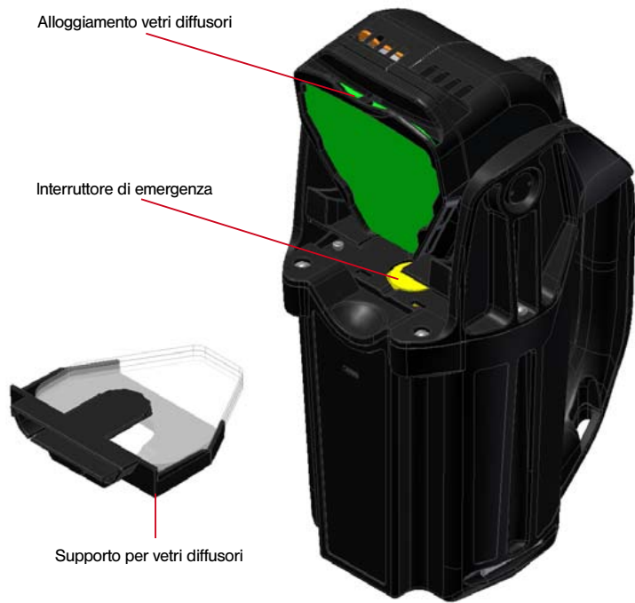
Figura 5 (interruttore di emergenza & vetri diffusori)
