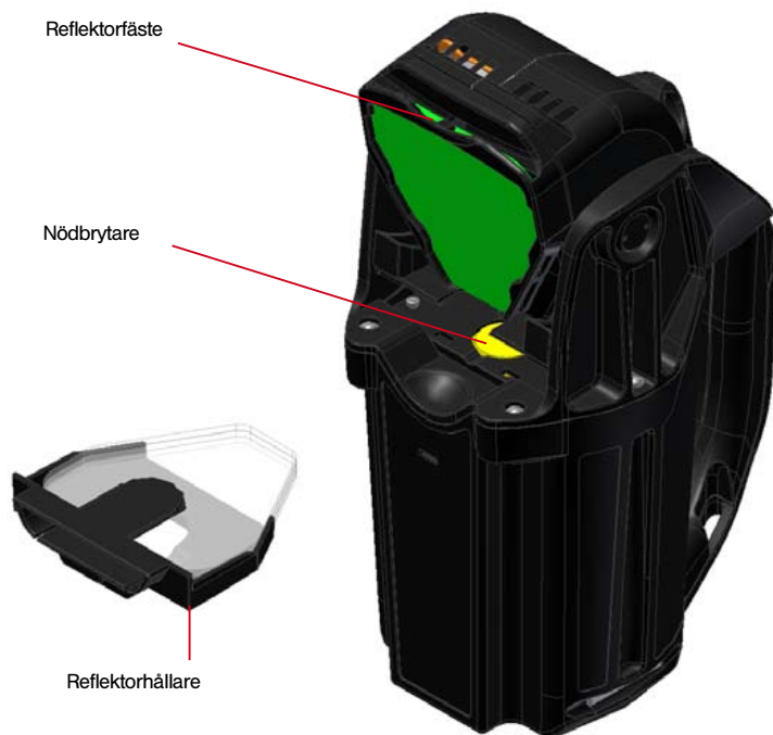
Bild 5 (Nödbrytare och reflektorer)
