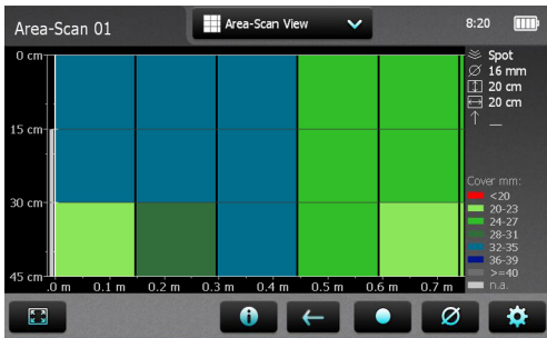
Abbildung 27: Flächenscanansicht (Vergrößerung so gewählt, dass X- und Y-Achse im selben Massstab angezeigt werden)
