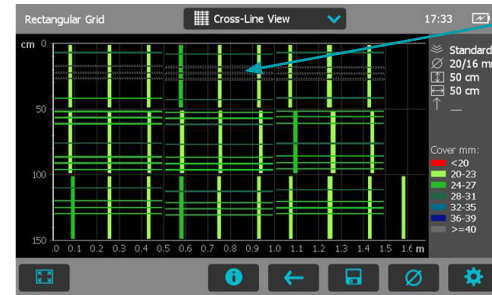
Abbildung 27: Flächenscanansicht (Vergrößerung so gewählt, dass X- und Y-Achse im selben Massstab angezeigt werden)
