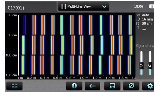
Abbildung 25: Mehrfachlinienansicht mit Farbspektrum für Signalstärke
