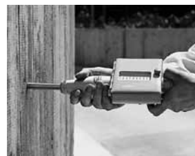
Fig. 2.2 Schlagbolzen (1) ausfahren (Modell NR abgebildet)
