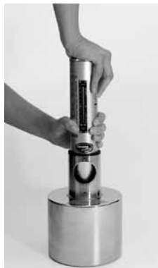
Fig. 3.1 Funktionskontrolle des Betonprüfhammers (Modell N/L abgebildet)
