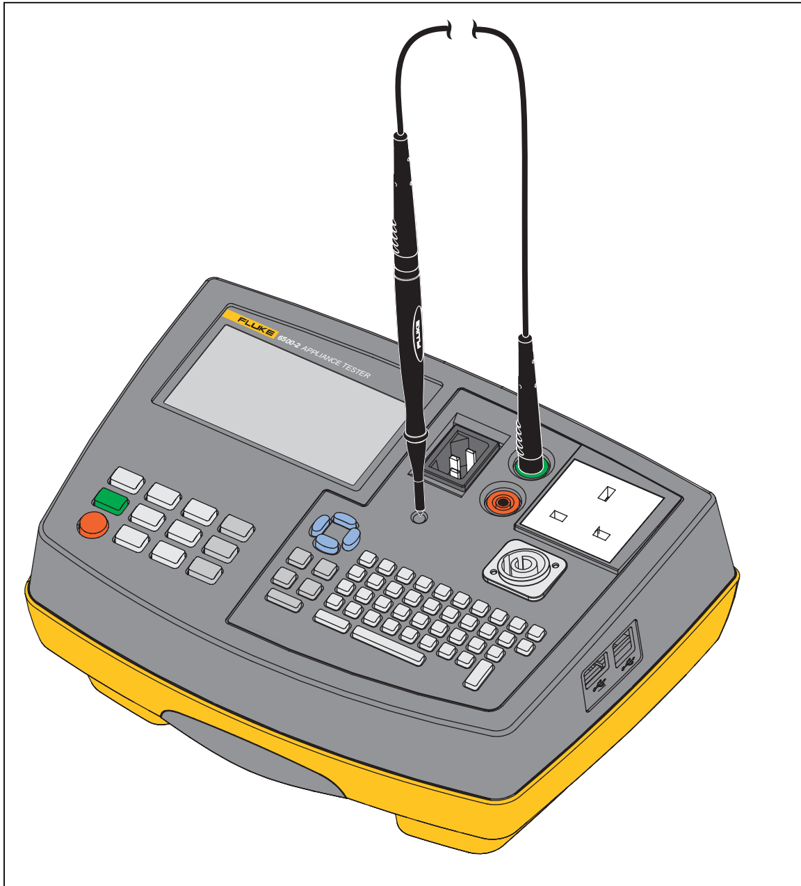
Abbildung 1. Kompensation der Messleitung
