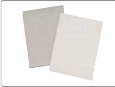
In Verbindung mit einem Set von Kalibrierfolien sind Nullplatten ideal um die Funktionsfähigkeit eines Schichtdickenmessgerätes zu testen und dieses zu kalibrieren, vor allem wenn es schwierig oder unmöglich ist, ein unbeschichtetes Substrat (Originaluntergrund) zu erhalten.
